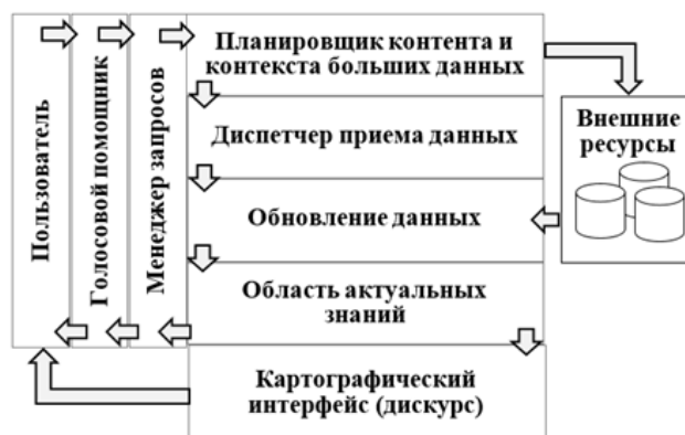
Рис. 1. Структурная схема системы мониторинга проблем развития отраслевой инфраструктуры ОиЭРИ на базе Ассистента с ИИ
