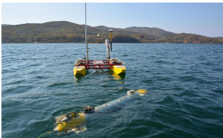
Рис. 2. АНПА и АНВА во время выполнения морского эксперимента
