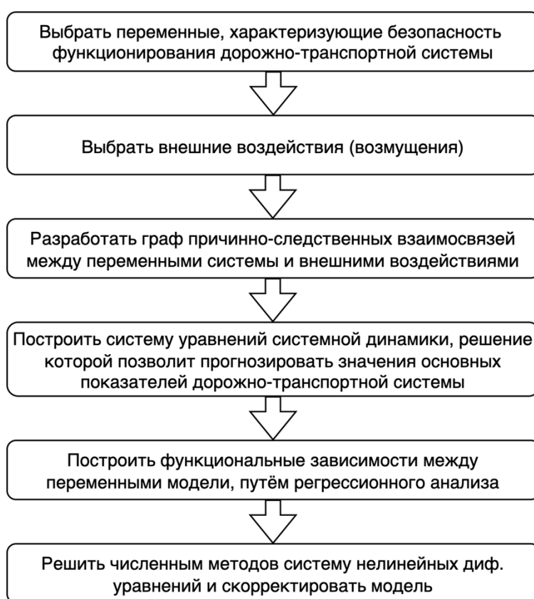
Рис. 2. Этапы разработки модели системной динамики для прогнозирования основных характеристик дорожно-транспортной системы
