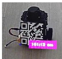
Рис. 4. Координаты положения робота на видео относительно центральной точки обзора камеры
